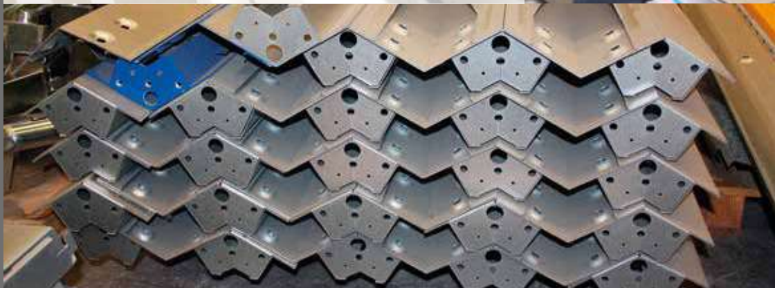
Il sistema Clever Crowning gestisce autonomamente la correzione dell'angolo di piega senza alcuna necessità di intervento da parte dell'operatore, garantendo una piega perfettamente lineare anche su materiali non uniformi. The Clever Crowning system independently manages the correction of the bend angle without any need for operator intervention, ensuring a perfectly linear bend even on uneven materials.
