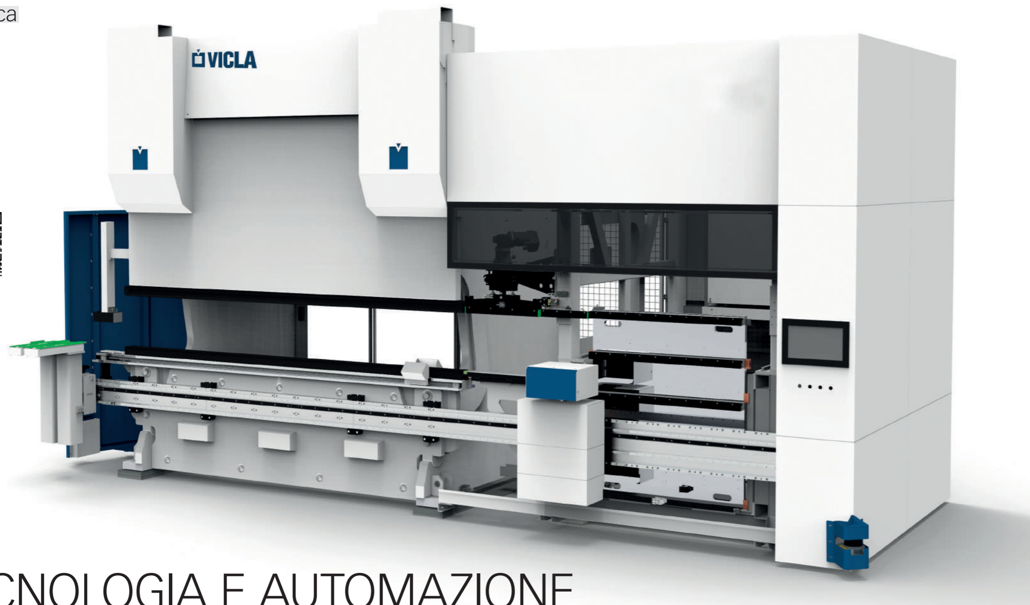
ATC VICLA - Singolo o Twin effettua automaticamente anche l'attrezzaggio più complesso, gestisce matrici fino a larghezza V da 70 mm, utensili portatondi e consente inoltre la rotazione dell'utensile di 180°.
