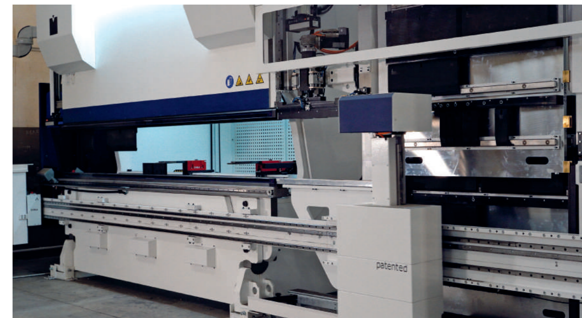
ATC VICLA - Singolo o Twin effettua automaticamente anche l'attrezzaggio più complesso, gestisce matrici fino a larghezza V da 70 mm, utensili portatondi e consente inoltre la rotazione dell'utensile di 180°.
